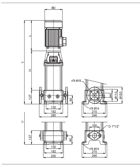
Disegni dimensionali, pesi e immagini sono unicamente indicativi e non vincolanti • Dimensional drawing, weight and picture are indicative only and not binding • Dimensiones, pesos y fotografías son indicativas y no vinculantes • Schemas d'encombrement, les poids et les images sont à titre indicatif et pas contraignantes • Габаритные чертежи, веса и изображения являются лишь ориентировочными, а не обязательными • Die Abmessungen, Gewichte und Bilder sind unverbindlich und verpflichtend.
